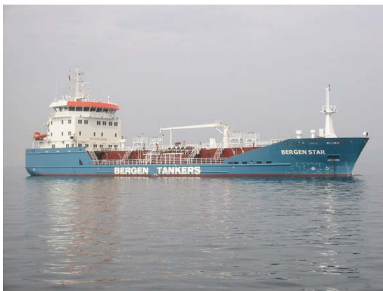
Figur 2.2 Kysttankbåten Bergen Star, 4.400 dwt, spesialutviklet for kysttankfart – byggeår 2006.
