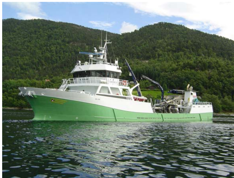
Figur 2.1 Brønnbåten Øyfjord, 700 dwt, spesialutviklet for frakt av levende fisk – byggeår 2003.
