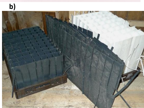
Figur 3.8. Lagringskasser for sjøkreps med sammenleggbare celler i ekstrudert plast. Løs topp og bunn av hard plast 40 x 60 cm.
