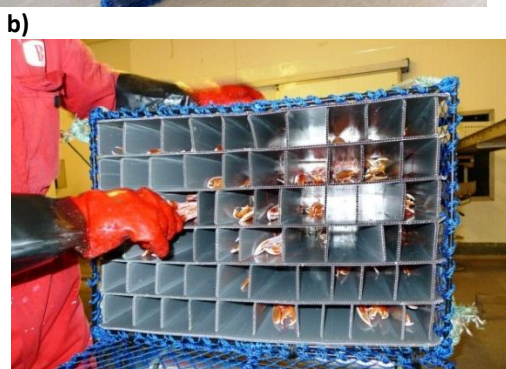
Figur 3.9. Lagringskasse for sjøkreps med fast ramme og lokk, kledd med not. Innmat 11 x 7 celler av ekstrudert plast.
