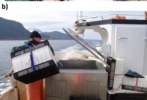
Figur 3.15. Fangst og lagring ombord i MS West Viking i 2009 og 2010. a) Påsett av lokk når lagringskassen er full. b) Innsett i lagringstank.
