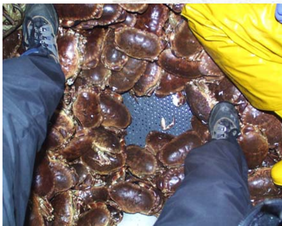
Figur 5.1 "Supercrabberen MFV "Peadar Elaine" kommer til kai og lossing starter. Bildet nederst til venstre viser den "falske" bunnen med perforering. Vannet pumpes inn i bunnen og perforeringa gjør at vannet fordeler seg jevnt gjennom hele laget med krabbe. Krabben lastes maksimalt 80 cm i høyden. Foto: A. Woll (Donegal, september 2000).
