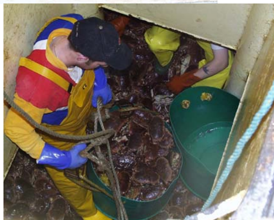
Figur 5.1 "Supercrabberen MFV "Peadar Elaine" kommer til kai og lossing starter. Bildet nederst til venstre viser den "falske" bunnen med perforering. Vannet pumpes inn i bunnen og perforeringa gjør at vannet fordeler seg jevnt gjennom hele laget med krabbe. Krabben lastes maksimalt 80 cm i høyden. Foto: A. Woll (Donegal, september 2000).
