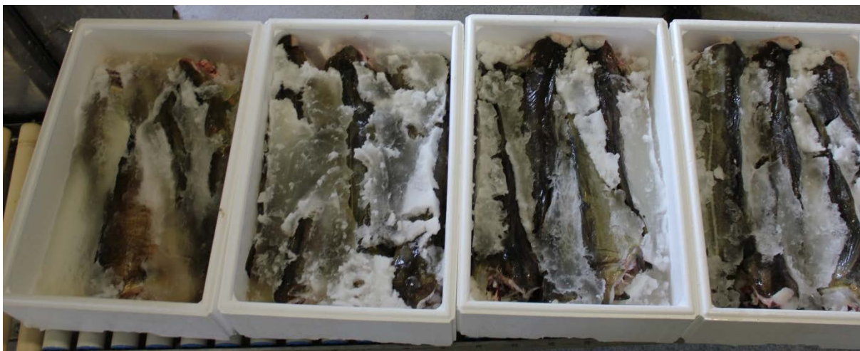
Figur 4.3. Torsk lagret på nanois i 5 dager ved 2 °C. I rekkefølge fra venstre ble fisken pakket i nanois med en gjennomstrømning (flow) på 400, 300, 250 og 150 liter/time. Høyere verdi indikerer mer flytende og tynnere konsistens på isen.
