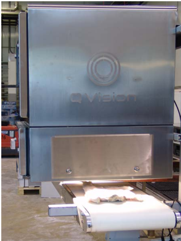
Bilde 1: Vannmåling med Q-vision.
