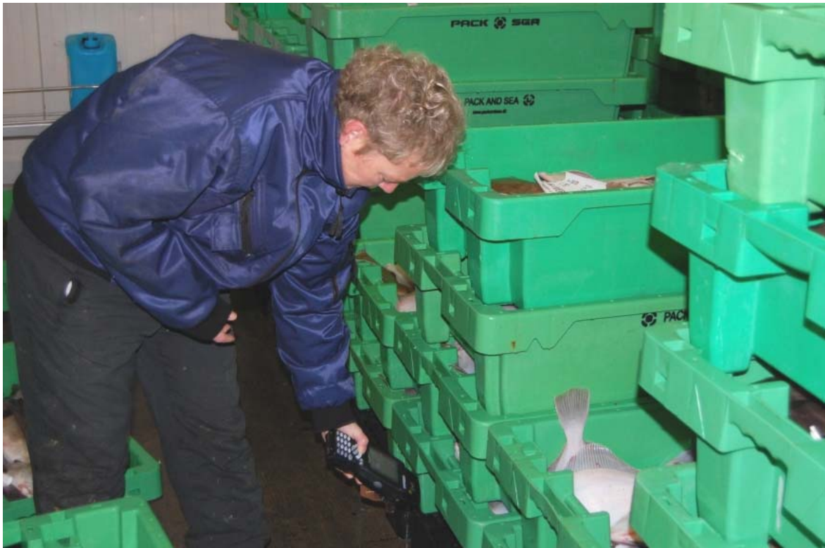
Figur 20 Registrering av ny leietaker for kasse ved fiskeauksjonen i Thyborøn ved hjelp av håndholdt RFID leser
