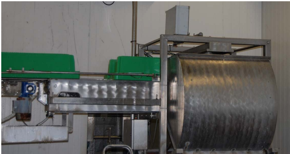
Figur 13 Del av vaskelinje for fiskekasser ved Thyborøn fiskeauksjon. Når fiskekassene passerer RFID leseren i den grå boksen øverst, blir hver kasse automatisk identifisert, og regnes da som tilbakelevert. (Foto: Ola Bø)
