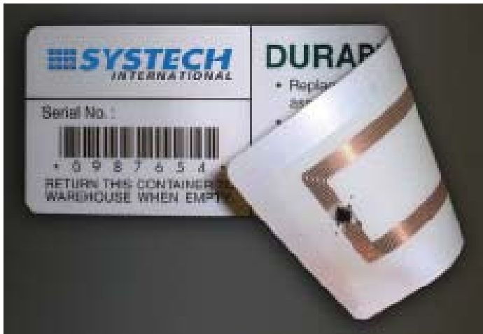
Figur 4 RFID-tag og strekkode kombinert på etikett (Kilde: idspackaging.com)
