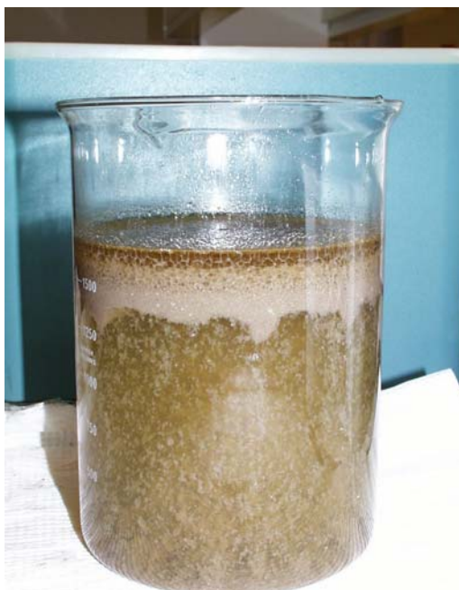
Figur 6. Proteinhydrolysat før separasjon av fasene.
