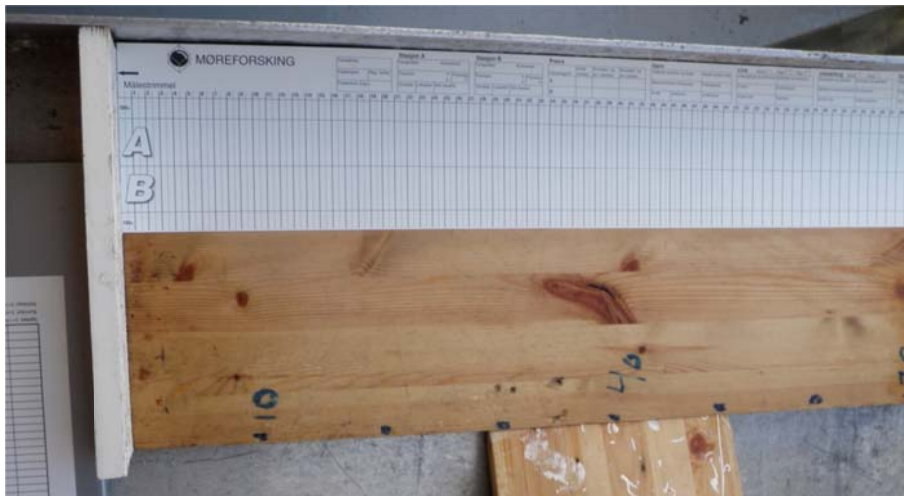
Bilde 3 Oppsett for lengdemåling. På den nedre del av fjølen ser en grovinn delt lengdeskala som ble benyttet for å anslå individlengder under første halvdel av toktet. På øvre del ligger et lengdemålings bånd, med cm oppløsning, som ble benyttet under siste halvdel av toktet.
