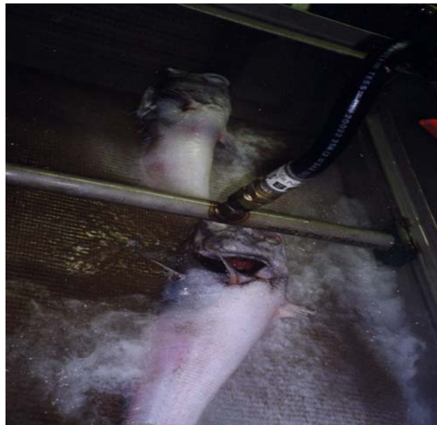
Figur 4. Uttesting av avreistingsmaskin ombord i M/Tr Korales
