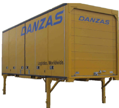
Figur 17: Illustrasjon av 25 fots vekselbeholder med mulighet for sidelasting
